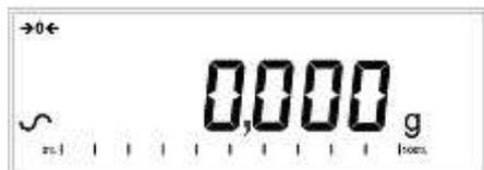
È buona norma lasciare l'analizzatore raggiungere una temperatura interna stabile prima dell'uso - normalmente 30 - 60 min tempo di riscaldamento è consigliabile.
