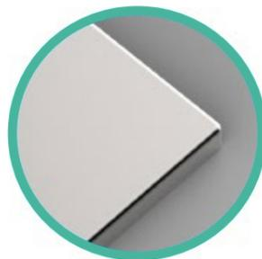
Il piano puo' essere realizzato, a seconda delle applicazioni, in lega AISI 304 o AISI 316. I piani di lavoro sono realizzati con lamiere presso-piegate a freddo. Il profilo, antidebordante e arrotondato, forma una superficie perfettamente liscia e continua, senza alcuna giuntura con il piano.
